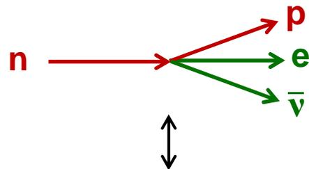
punktförmiger Vertex, an dem ein Neutron vernichtet und ein Proton, ein Elektron und ein Antineutrino erzeugt werden.
