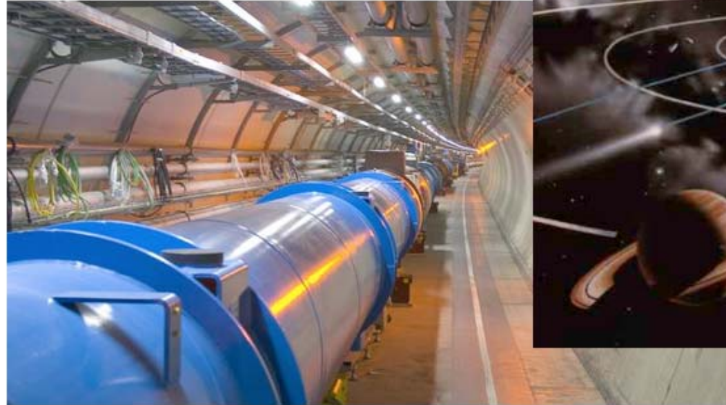
Large Hadron Collider (LHC), CERN, Genf; 27 km Umfang, supraleitende Magnete
