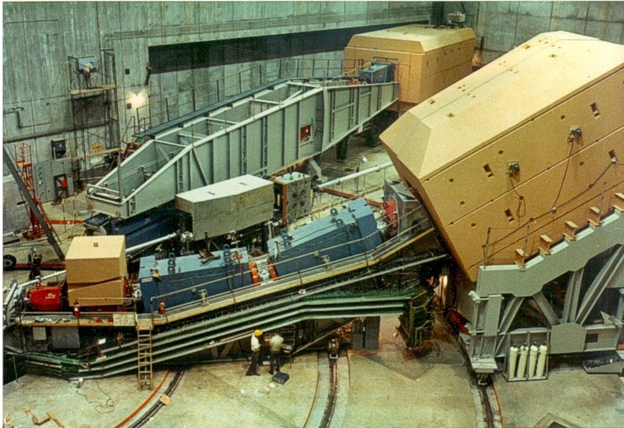
Die drei Spektrometer der MIT-SLAC-Experimente: vorne das 8GeV-Spektrometer, dahinter das 20 GeV-Spektrometer, ganz links am Rand ist gerade noch das 1.6 GeV-Spektrometer zu sehen.
