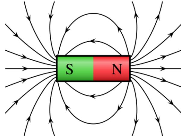
Magnetfeld eines Stabmagneten
