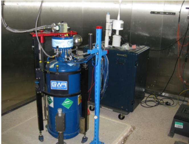
Eine supraleitende Probemasse ist in einem Magnetfeld aufgehängt, das von Strömen in supraleitenden Spulen erzeugt wird. Das SG056 am BFO ist ein Doppelkugelgerät mit zwei Sensoren.
