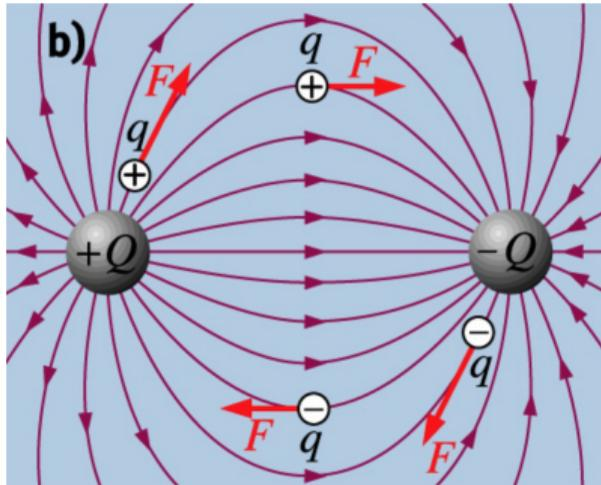
Das elektrische Feld eines Dipols und die Kraft auf eine Probeladung
