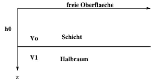
Schicht über Halbraum.  $h_0 = 100m$ ,  $V_{p0} = 1000m/s$ ,  $V_{p1} = 3000m/s$ ,  $V_{s0} = 500m/s$ ,  $V_{s1} = 1500m/s$ , .
