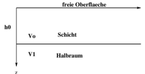
Schicht über Halbraum.  $h_0 = 100m$ ,  $V_{p0} = 1000m/s$ ,  $V_{p1} = 3000m/s$ .
