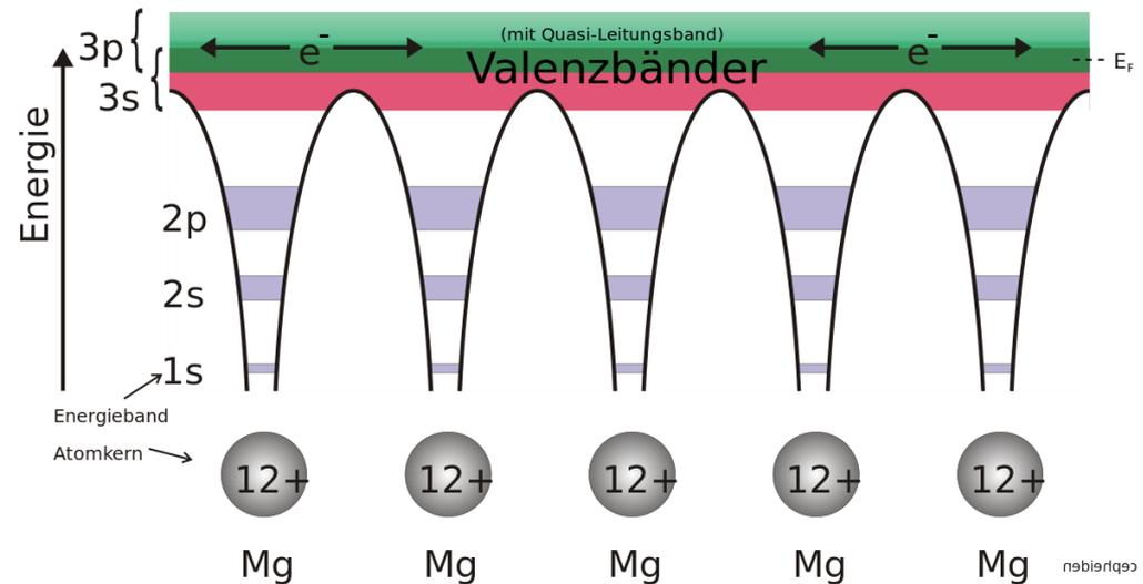
In Bändern mit feinen Zuständen sind Elektronen leicht beweglich. Elektronen aus vollständig besetzten Bändern benötigen zunächst Energie, um in ein Band mit freien Zuständen zu gelangen.
