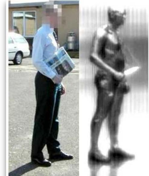
Durchleuchtung mit Terahertz-Strahlung. Mann mit verstecktem Messer: "Entdeckung von Waffen und Sprengstoff wird einfacher". Foto: Qinetiq
