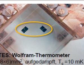
schnelles Signal, Auslese durch **supraleitende Sensoren: TES** (Transition **E**dge **S**ensor),
