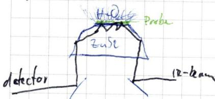
Totalreflexion an Grenzfläche. Wellen dringen aber trotz Totalreflexion in Probe ein und werden dort abgeschwächt. Durch geringe Penetrationslänge ( $\sim 1 \mu\text{m}$ ) hat das Wasser oben drüber keinen Einfluss
