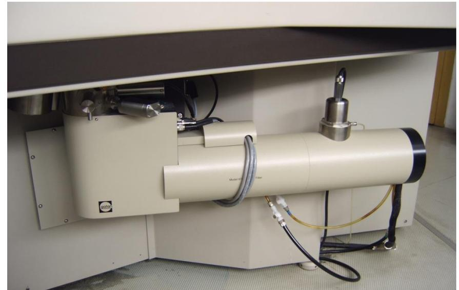
Kombiniertes (Raster)Transmissionselektronenmikroskop TEM/STEM Philips CM 20 mit (abbildendem) Elektronenenergie-Verlustspektrometer (Abbildung rechts)
