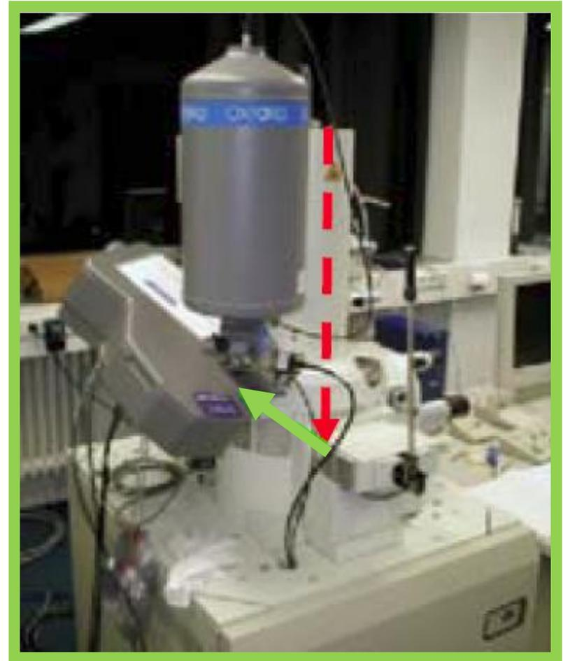
Anordnung eines WDX-Spektrometers an einem Rasterelektronenmikroskop
