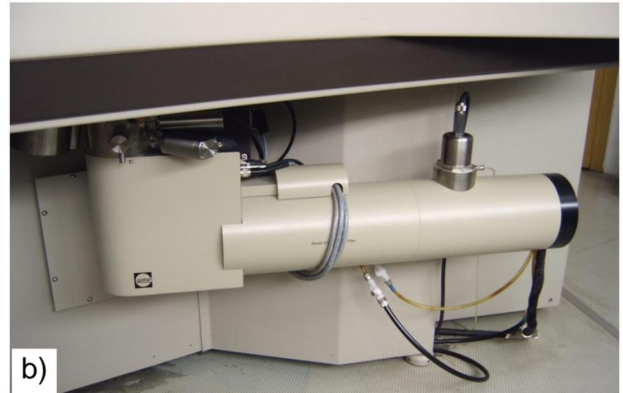
(a) Kombiniertes (Raster) Transmissionselektronenmikroskop mit (b) Spektrometer (Gatan imaging filter: GIF)
