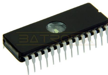
Abb. 15.4 Bild des EPROM M27C64A-10F6 mit Quarzfenster.
