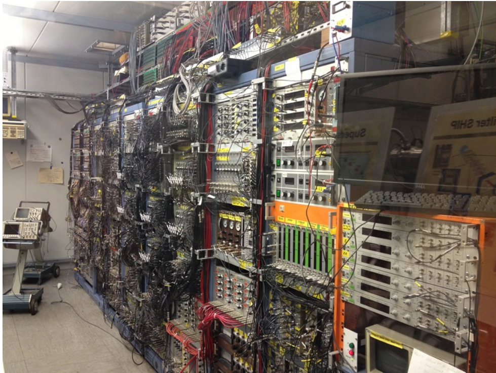
Abb. 12.19 Elektronikmodule und Logikbausteine zur Suche nach schweren Elementen an der GSI.
