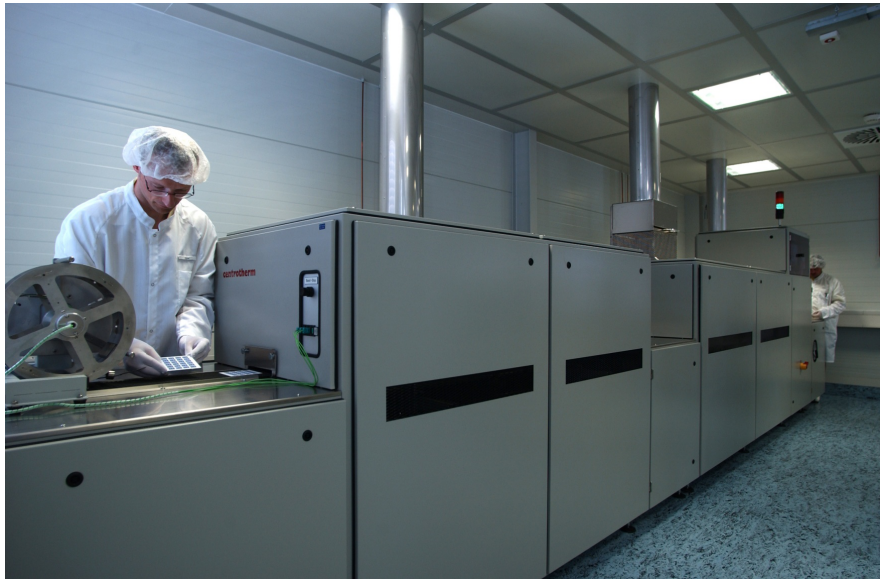
Abb. 18.4 Sinterofen für den Dickschichtdruck auf Keramiksubstraten.
