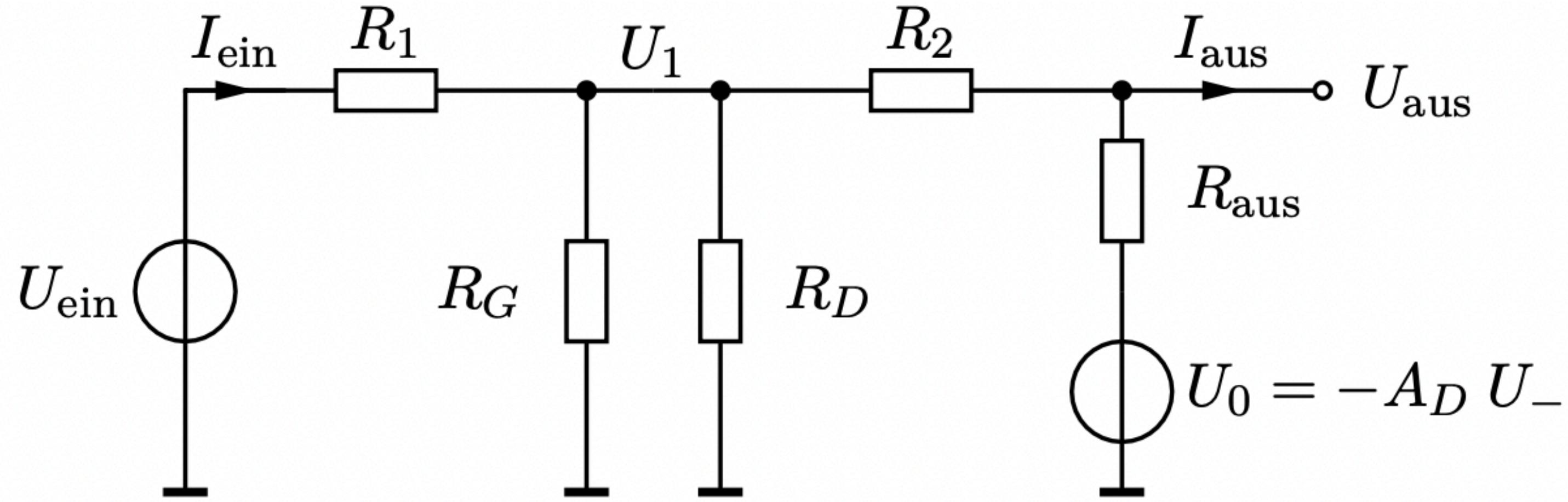
$$U_- = U_{ein} \frac{R}{R_1 + R} - A_D U_- \frac{R_1}{R + R_1} \quad \Rightarrow \quad U_- = U_{ein} \frac{R}{R + R_1 + R_1 A_D}$$
