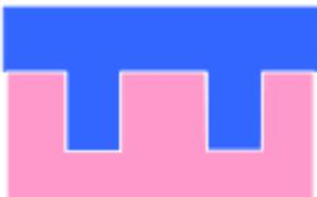
f) Vervielfältigung durch Kunststoffabformung der Metallstruktur
