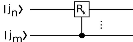
Abbildung 1: Schematische Zeichnung des Controlled-Phase-Gate.  $|j_n\rangle$  ist hierbei der Ziel Qubit und  $|j_m\rangle$  der Kontroll-Qubit.
