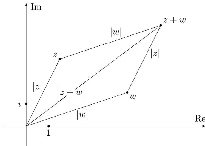
**Polarkoordinaten und Eulerformel:** Eine komplexe Zahl  $z = x + iy$  (wobei  $x, y \in \mathbb{R}$ ) kann man schreiben mithilfe ihres Betrages  $r = |z|$  und des Winkels  $\varphi$  zur positiven  $x$ -Achse (dh mithilfe von *Polarkoordinaten*). Es ist nämlich  $x = r \cos \varphi$  und  $y = r \sin \varphi$  nach Schulmathematik. Verwendet man die *Eulerformel*
