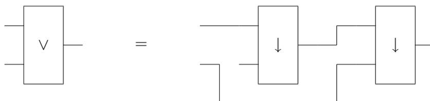
Hier wird also der untere Eingang des linken  $\rightarrow$ -Gatters nirgends angeschlossen, so dass er stets ohne Spannung bleibt. Auf diese Weise wirkt das linke  $\rightarrow$ -Gatter dann wie ein  $\neg$ -Gatter auf seinen oberen Eingang – symbolisch geschrieben:  $\neg A = (A \rightarrow \text{falsch})$ . Die Richtigkeit des Bauplans ergibt sich dann aus der Gleichheit  $A \vee B = (\neg A) \rightarrow B$ .
