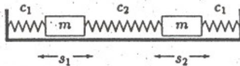
Die linke Feder wird um  $s_1$ , die rechte um  $s_2$  ausgebucht. Die Dehnung der mittleren Feder ist dann  $s_2 - s_1$ .
