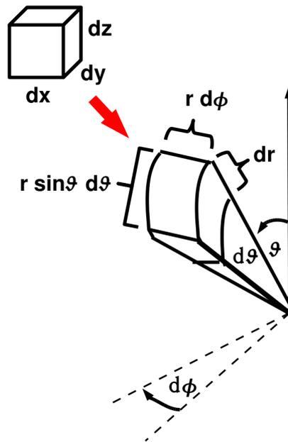
Abbildung 2: Volumenelement bei Transformation
