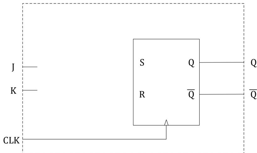
Abbildung 7.3: RS-Flipflop zur Erzeugung eines JK-Flipflops
