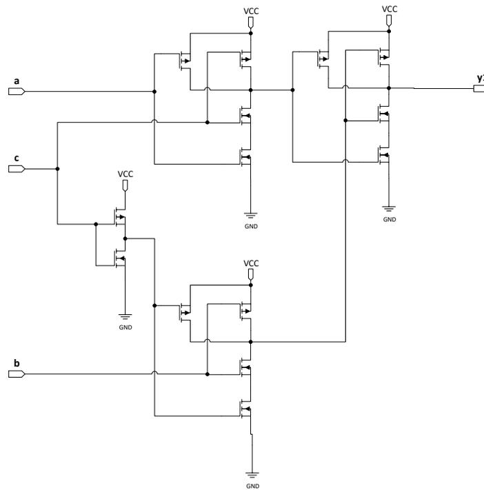
Abbildung 8.2: CMOS-Schaltung aus mehreren Gattern
