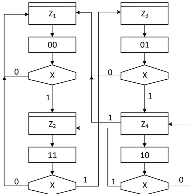
Abbildung 4.2: Ablaufdiagramm eines Automaten
