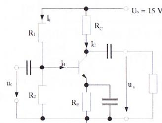
Um eine hohe Verstärkung zu erhalten, muss ein Kondensator parallel zu RE geschaltet werden (für Kleinsignalbetrieb erhalten wir dann eine einfache Emitterschaltung)
