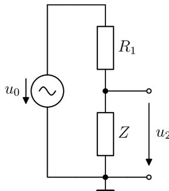
Abbildung 3: Ersatzschaltbild mit  $Z = R_2 \parallel j\omega L$ .
