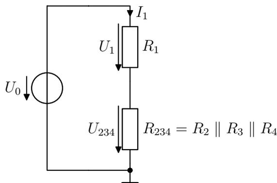
**Abbildung 2:** Vereinfachte Schaltung zur Anwendung der Spannungsteilerregel.
