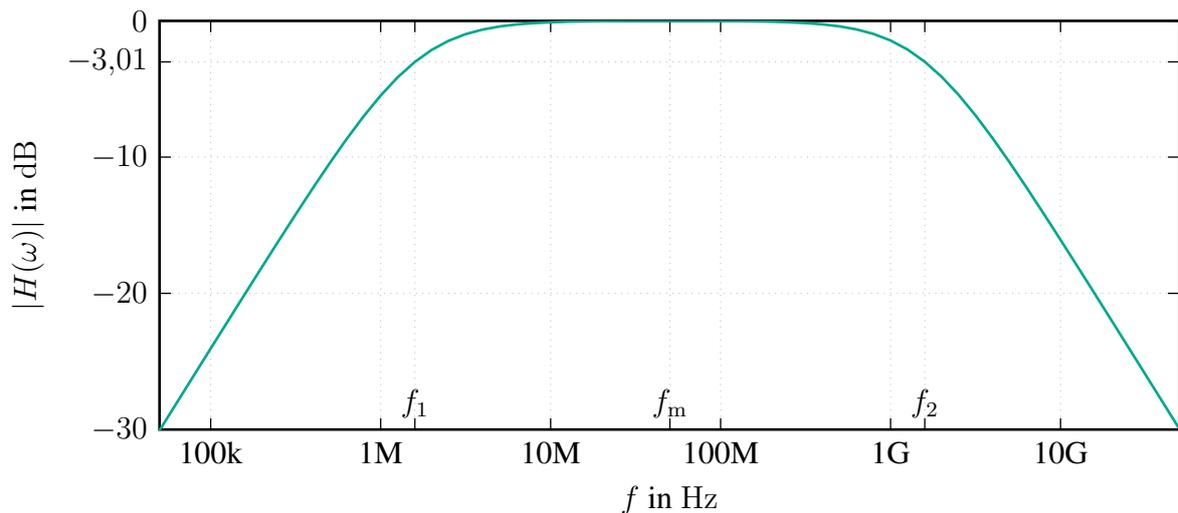
**Abbildung 5:** Simulierter Frequenzverlauf von  $|H(\omega)|$  aus LTSpice mit markierten Knickfrequenzen  $f_{1,2}$  und Mittenfrequenz  $f_m$ .
