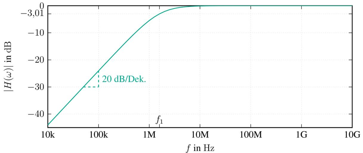
**Abbildung 4:** Simulierter Frequenzverlauf von  $|H(\omega)|$  aus LTspice mit markierter Knickfrequenz  $f_1$ .
