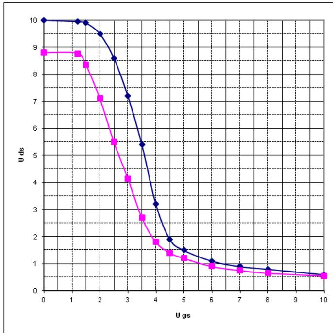
26.2 Ermitteln Sie aus dem Kennlinienfeld die Steilheit  $S$  des Transistors zwischen  $U_{GS} = 2\text{ V}$  und  $U_{GS} = 3\text{ V}$  und zwischen  $U_{GS} = 3,5\text{ V}$  und  $U_{GS} = 4,5\text{ V}$  !
