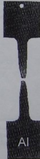
Bild 1.7: Ergebnis eines Zugversuches mit einer Al-Probe
