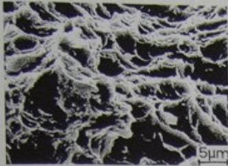
örtliche Verformungen unter Schubspannungseinwirkung
