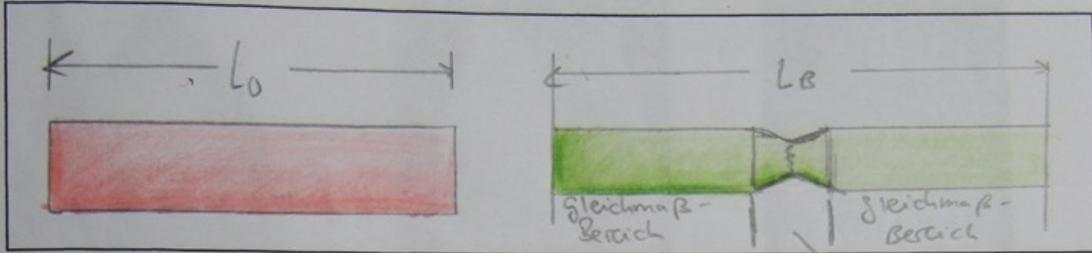
Bild 11.10: Zugprobe im Ausgangszustand und im eingeschnürten Zustand
