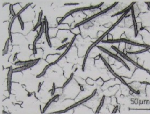
Ferritisches Gußeisen mit Lamellengraphit
