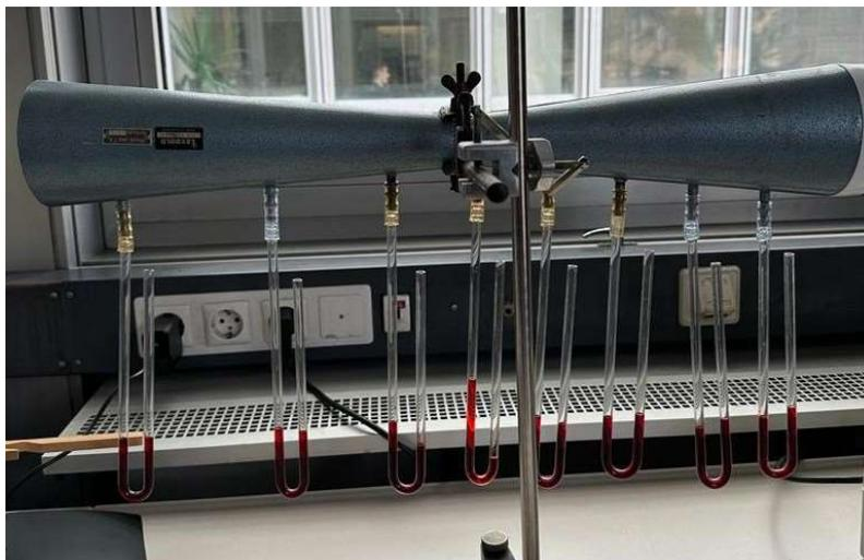
Abbildung 3: Druckdifferenzen im Venturi-Rohr
