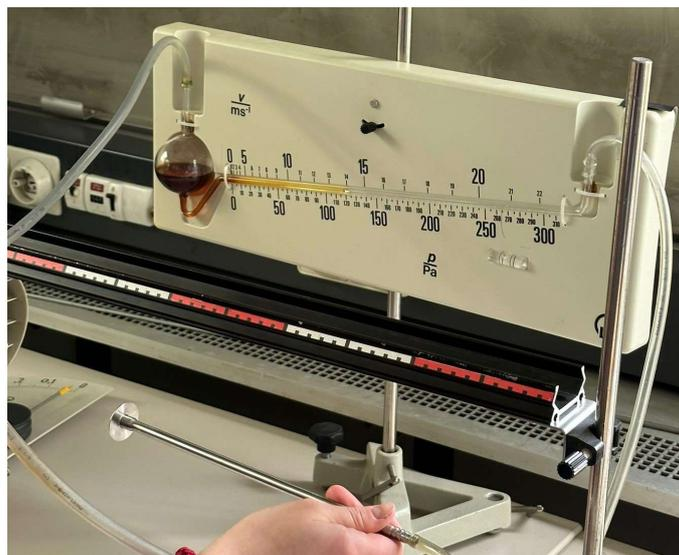
Abbildung 2: Druckmessung mit der Scheibensonde
