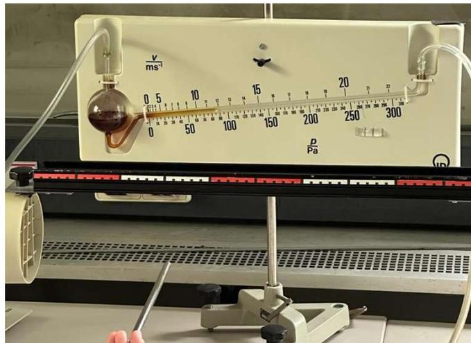
Abbildung 1: Statische Druckmessung mit der Rohrsonde
