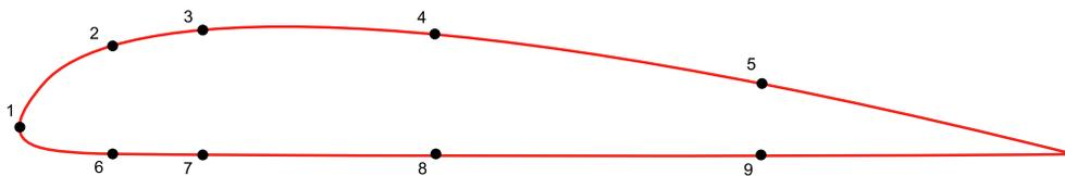
Abbildung 7: Lage und Bezeichnung der Druckmessstellen
