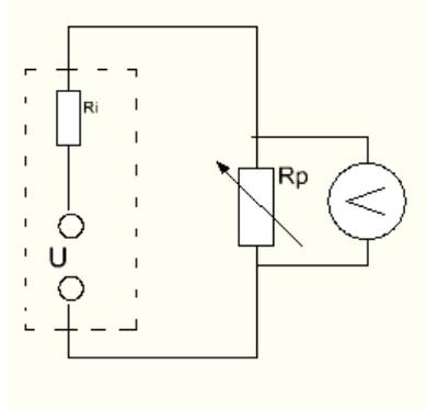
Abbildung 2.4: Innenwiderstand des Sinusgenerators
