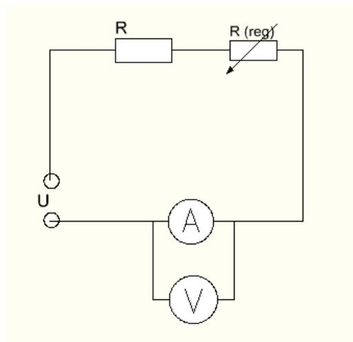
Abbildung 1.1: Innenwiderstand des  $\mu\text{A}$  Multizets
