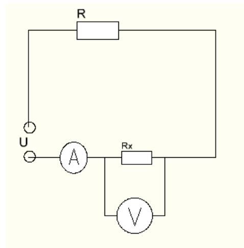
Abbildung 1.2: Spannungsrichtige Schaltung
