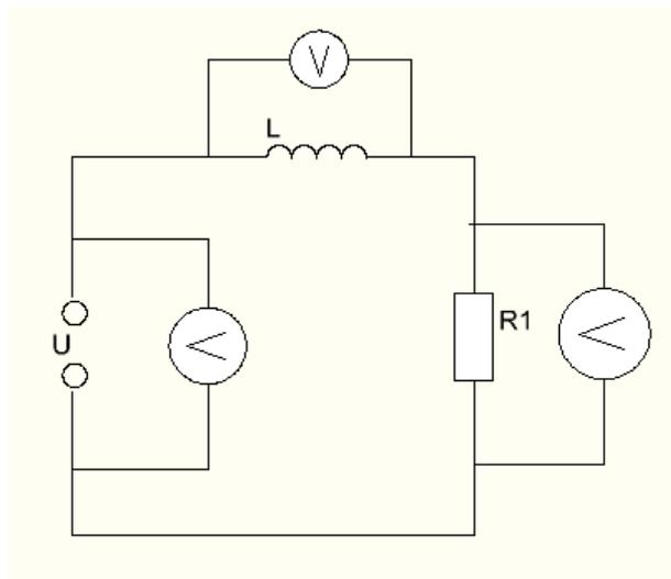
Abbildung 2.1: Spule in Reihe mit einem Widerstand
