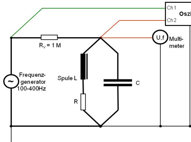
Abbildung 2.3: Parallelschwingkreis (Quelle: Aufgabenblatt)
