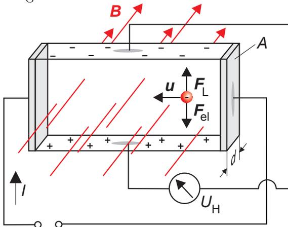
Aus der Bedingung:  $q \cdot \vec{E} = -q(\vec{v} \times \vec{B})$  folgt mit der Stromdichte  $\vec{j} = n \cdot q \cdot \vec{v}$  ergibt sich die Hallspannung zu:
