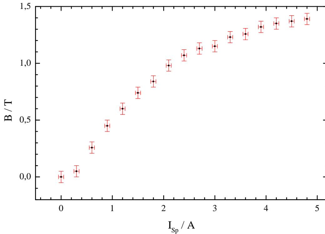
Abbildung 1: B-Feld über Spulenstrom
