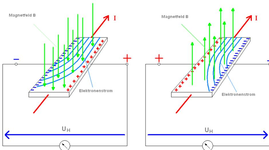
Mittels obiger Skizze soll kurz der Hall-Effekt erläutert werden. An der Hallsonde liegt eine Spannung derart an, dass sie vom Strom der Stärke  $I$  durchflossen werde. Bringt man diese Sonde in ein möglichst homogenes Magnetfeld, dessen Richtung durch die Pfeile angedeutet ist, so erfahren die Elektronen als bewegte Ladungen mit der Geschwindigkeit  $v$  und der Elementarladung  $e$  im Magnetfeld eine Lorentzkraft
