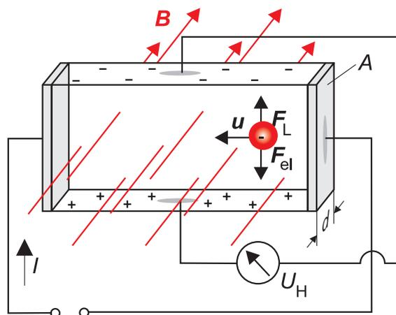
Ein mit dem Strom  $I$  durchflossener Leiter wird so in das zu messende Magnetfeld  $B$  eingebracht, dass die Stromflussrichtung senkrecht zur Richtung der Magnetfeldlinien gerichtet ist. Da auf die bewegten
