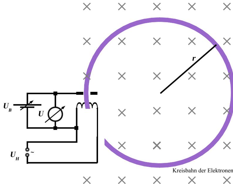
Ein solches besteht in der Regel aus einem evakuierten, kugelförmigen Glaskolben, in welchen geringe Mengen Gas, beispielsweise Wasserstoff, eingebracht werden. Durch eine Elektronenkanone kann ein “Faden” aus Elektronen ins Kugellinnere geschossen werden, welcher mit den Wasserstoffatomen wechselwirkt und diese zum Leuchten anregt. Dadurch kann der Faden direkt sichtbar gemacht werden. Ein Helmholtzspulenpaar an den Seiten des Glaskolbens sorgt im Inneren für ein nahezu homogenes Magnetfeld.
