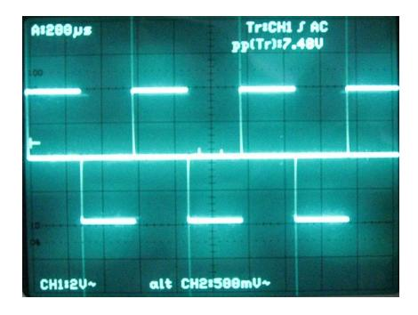
Das Bild zeigt die Ableitung einer Reckteckspannung. Beim sprunghaften Übergang von positivem zu negativem Spannungswert und umgekehrt ergeben sich Spannungsspitzen, da die Ableitung an diesen Stellen theoretisch unendlich groß ist. Da das Eingangssignal ansonsten konstant verläuft, ist das Ausgangssignal Null.
