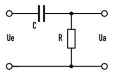
Bei unserem Versuch soll die Ausgangsspannung für verschiedene Widerstände bei konstanter Kapazität gemessen werden, sowie die zeitliche Verschiebung zwischen der Eingangs- und Ausgangsspannung.
