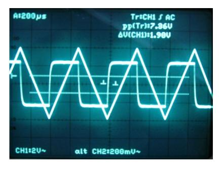
Die Rechteckspannung ist immer noch deutlich erkennbar, allerdings an den Kanten etwas abgerundet, dafür ist das Signal selbst klarer erkennbar.
