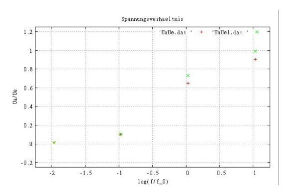
Für kleine Widerstände (Frequenzen) ist die Ausgangssignal sehr schwach und nähert sich mit zunehmendem Widerstand (Frequenz) der Eingangsspannung.
