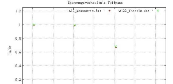
Die Wirkungsweise eines Tiefpasses ist klar zu erkenne. Für kleine Widerstände, bzw. geringe Frequenzen kann fast die gesamte Eingansspannung am Kondensator abgegriffen werden, während für große Lastwiderstände, somit großen Frequenzen das Ausgangssignal sehr gering ist.
