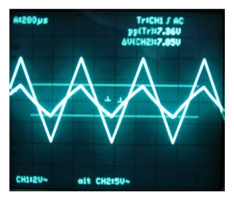
Das Ausgangssignal gleicht in seiner Form und wegen des hohen Lastwiderstandes auch in den Spannungsspitzenwerten dem Eingangssignal.
