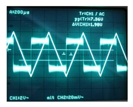
Das Ausgangssignal ist zwar schwach, aber die Rechtecksform ist gut ausgebildet und erkennbar. Die Vorzeichenwechsel in der Ausgangsspannung sind zur gleichen Zeit wie der Steigungswechsel bei der Eingangsspannung
