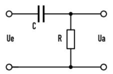
Anstatt die Frequenz zu ändern, haben wir den verwendeten Widerstand ausgetauscht. Bei konstanter Frequenz bleibt der Blindwiderstand des Kondensators  $(C \approx 1 \text{nF})$  konstant, weshalb wir den Lastwiderstand austauschen mussten. Dieses Verfahren ist gleichbedeutend mit einem konstanten Lastwiderstand zu arbeiten und den Blindwiderstand des Kondensators durch eine Frequenzänderung zu regulieren. Als Lastwiderstände standen uns  $R=1,10,100,100\,k\,\Omega$  zur Verfügung.
