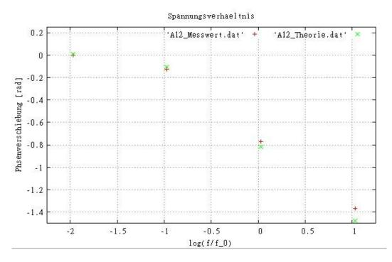
Zunächst sind Eingangs- und Ausgangsspannung in Phase und mit steigendem Widerstand, bzw. steigender Frequenz ist eine Phasenverschiebung zu erkennen die gegen den Wert
