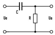
Mit der Kirchhoffschen Regel gilt für die Ausgangsspannung:
