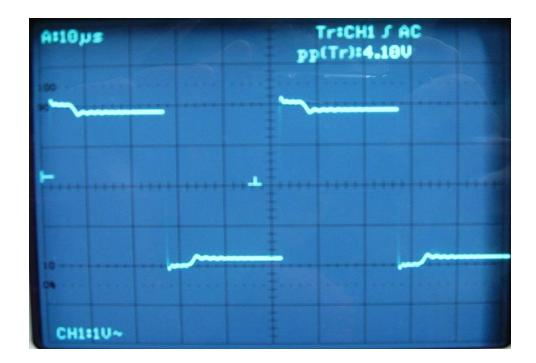
Durch die Reflexion am Kettenende erwarteten wir eine treppenförmige Abschwächung des Signals, die in unserem Bild auch leicht erkennbar ist.
