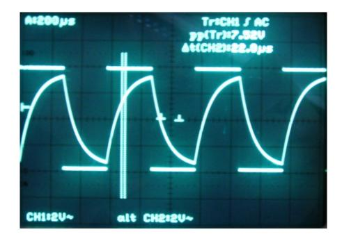
Das Ausgangssignal ist eine Sägezahnfunktion und lässt eine Dreieckspannung zumindest erahnen. Beim Vergleich mit der Theorie ist der Unterschied deutlich.
