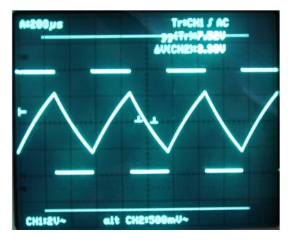
Die Dreieckspannung ist gut erkennbar und abgesehen von leichten Wölbungen fast perfekt. Die Vorzeichenwechsel in der Steigung passen genau mit der Spannungsumkehrung überein.
