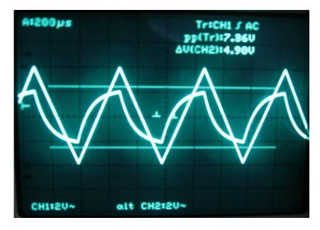
Der Übergang von der Rechteckspannung in die Dreieckspannung ist gut zu erkennen. Das Ausgangssignal hat nur noch einen Punkt mit Maximaler Spannung.
