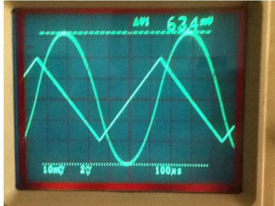
Abbildung 2.5: Dreiecksspannung an Tiefpass
