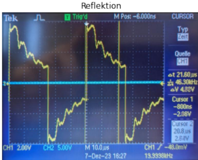
Hier ist keine sinnvolle Aussage über die Reflektion möglich, da keine genaue Abgrenzung der reflektierten Welle möglich ist. Es ist lediglich erkennbar, dass es Verzerrungen im Signal gibt. Dies könnte daran liegen, dass der Eingangswiderstand unserer Drosselkette defekt war und somit Mehrfachreflektionen am Eingang möglich waren, die das Signal verzerrt haben.
