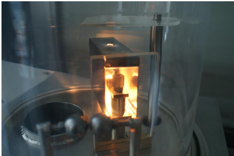
Abbildung 8: Aufdampfapparat. Im Vordergrund befinden sich die Kugeln für den Spannungsdurchschlagsversuch. Im Kasten dahinter befindet sich die glühende Indiumprobe. Durch die Lochblende in der Decke des Kastens fällt ein Lichtstrahl auf die Plexiglasscheibe darüber, der schon von einem verschwommenen Indiumfleck umgeben ist.
