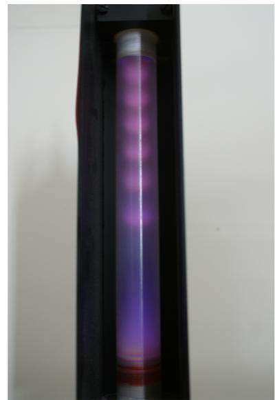
Abbildung 1: evakuierte Gasentladungsröhre. Sowohl das diffuse Hintergrundleuchten als auch die Bereiche stärkerer Anregung mit den Abständen  $\hat{=}$ mittlere freie Weglänge sind gut zu erkennen.
