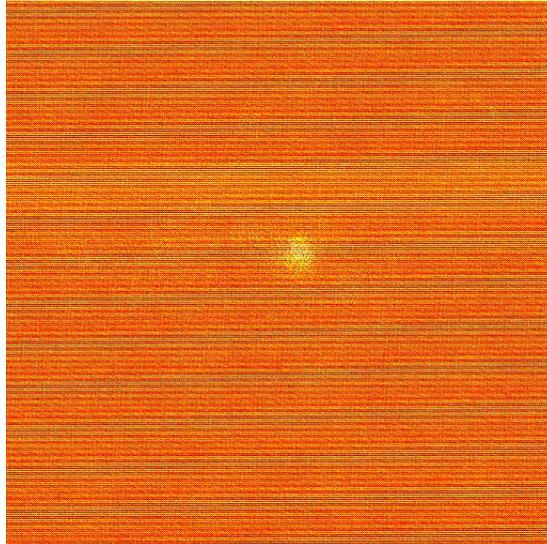
Abbildung 7: Fluoreszierende Kugel in Falschfarbendarstellung als heller Fleck in der Bildmitte. Die horizontalen Streifen sind Interferenzeffekte, die durch das Abrastern auftreten.
