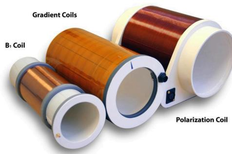
Abbildung 2.0.2: EFNMR/ MRI Spulen (aus Vorbereitungsmappe)
