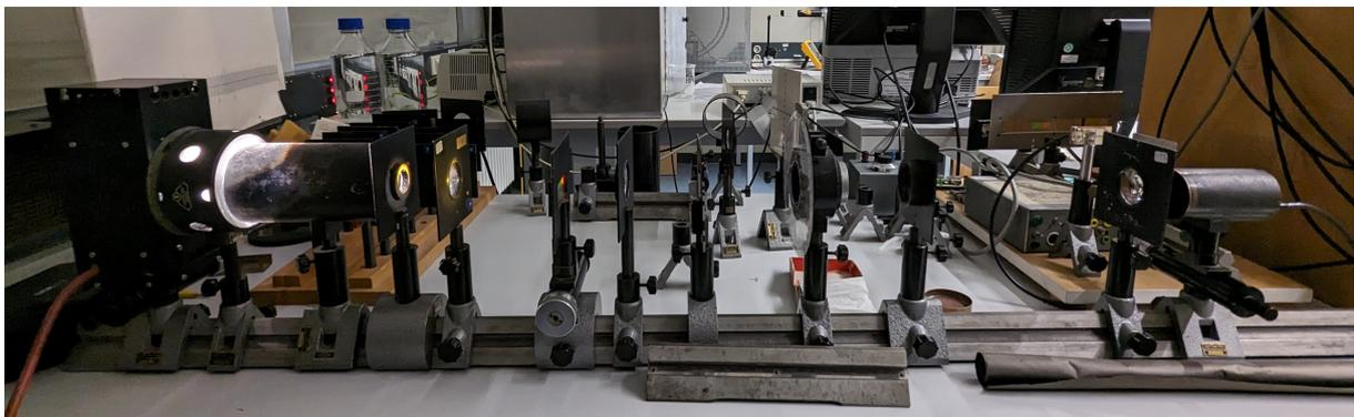
Abbildung 2.1: Foto des optischen Teils des Versuchsaufbaus. Von links nach rechts: Halogenlampe, Linse, verstellbarer Wellenlängenfilter, Linse, fester Polarisationsfilter, verstellbarer Polarisationsfilter, Linse, Photowiderstand
