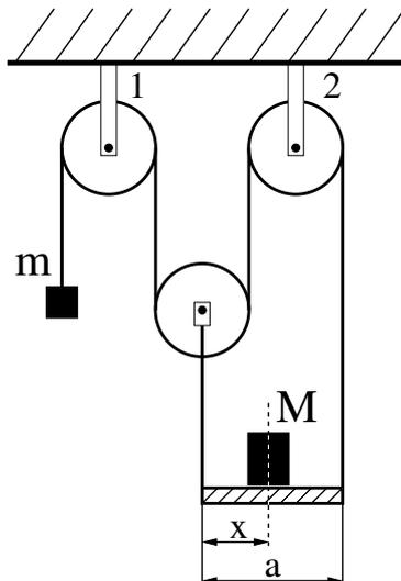
Nehmen Sie an, das Verhältnis der Abstände  $x/a$  sei so bestimmt, dass die Querverbindung nicht kippt und  $M$  nicht von der Querverbindung rutscht. Die Rolle 1 sei zunächst festgehalten, kann sich aber vom Zeitpunkt  $t_0 = 0$  an reibungsfrei drehen.
