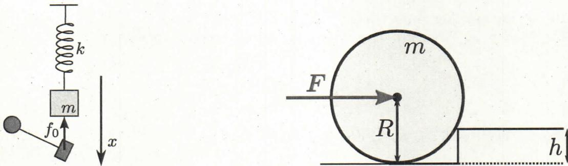
Abbildung 1: Links: Abbildung zu Aufgabe 3. Der Hammer übt die vertikale Kraft  $f_0(t) = p_0[-\delta(t) + -\delta(t - \pi/\omega_0)]$  im Teil (c) der Aufgabe aus. In Teil (b) ist keine externe Kraft vorhanden. Rechts: Abbildung zu Aufgabe 4.
