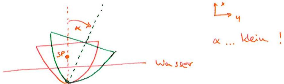
Das Schiff erfährt auf der jeweiligen Seite einen zusätzlichen Auftrieb prop. zum Volumen  $\Delta V$ .
