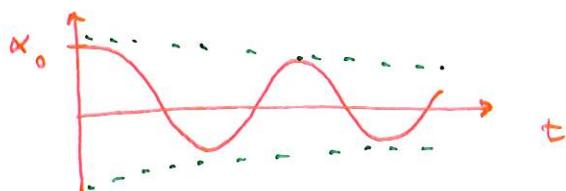
Schwingung mit einklappendem e-Fakt. (Dämpfung)
