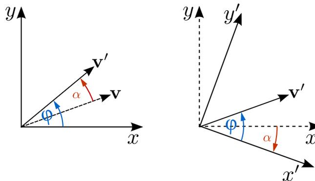
Abbildung 1: **(Rechts)** Drehung eines Koordinatensystems  $(x, y) \xrightarrow{-\alpha} (x', y')$  um den Winkel  $-\alpha$ . **(Links)** Drehung eines Vektors  $\mathbf{v}$  um den Winkel  $\alpha$  in einem festen Koordinatensystem  $(x, y)$  ergibt ein äquivalentes Resultat wie auf dem **rechten** Bild.
