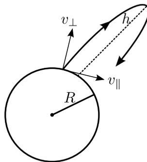
Abbildung 1: Eine langreichweitige Rakete wird von der Erdoberfläche mit einer Anfangsgeschwindigkeit  $\mathbf{v} = (v_{\parallel}, v_{\perp})$  abgeschossen.
