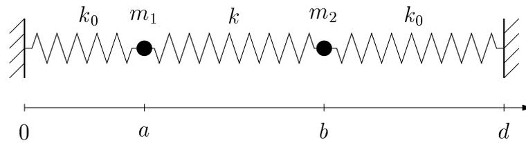
Die beiden Massen  $m_1 = m_2 = m$  sind mit einer Feder (Federkonstante  $k$ ) gekoppelt und mit Federn (Federkonstante  $k_0$ ) zwischen zwei festen Wänden angebracht. Betrachtet werden soll die eindimensionale Bewegung, wobei die Ruhelagen der Massen durch die Punkte  $a$  und  $b$  gegeben sind.
