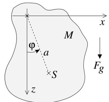
**6** Eine Unruh (Rotationsfederpendel) besteht aus einem zylinderförmigen Körper, der um die  $z$ -Achse drehbar gelagert ist. Das Trägheitsmoment  $\Theta_{zz}$  bezüglich dieser Achse sei bekannt. Für gegebenen Drehwinkel  $\varphi$  aus der Ruhelage bewirkt eine Feder (in der Skizze nicht eingezeichnet) ein Drehmoment  $\mathbf{N} = -KR\varphi \mathbf{e}_z$ ,  $K, R = \text{const.}$
