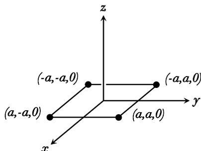
Abbildung 1: Masselose quadratische Platte mit vier Teilchen der Masse  $m$  an den Ecken.
