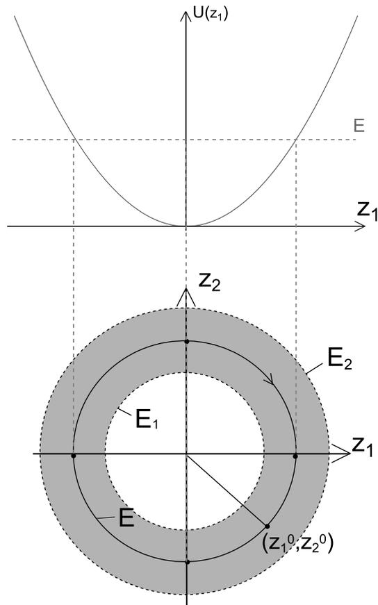
Bewegung im Phasenraum liegt auf einem Kreis. Verschiedene Energien entsprechen verschiedenen Radien des Kreises. Die Kreisfrequenz ist für alle Energien dieselbe. Die Zustände mit  $E_1 \leq E \leq E_2$  belegen ein bestimmtes Volumen im Phasenraum; dieses entspricht der Fläche des entsprechenden Kreisringes.
