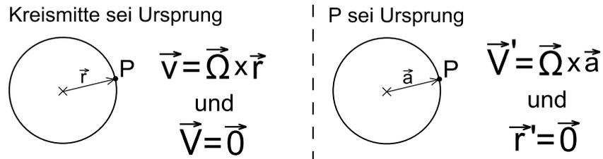
Falls  $\vec{V} \perp \vec{\Omega}$  zu einem bestimmten Zeitpunkt gilt, also  $\vec{\Omega} \cdot \vec{V} = 0$ , so folgt daraus  $\vec{V}' \perp \vec{\Omega}$  für ein beliebiges körperfestes System, da
