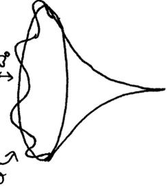
Die Bewegung ist eine Folge des Wechselspiels zwischen Schwerkraft und Zentrifugalkraft. Da die Steigung des Trichters und damit die Komponenten von diesen Kräften parallel zur Innerfläche von der Höhe  $z_0$  abhängen, ist es nicht überraschend, dass  $z_0$  auch  $z_0$  abhängig ist.
